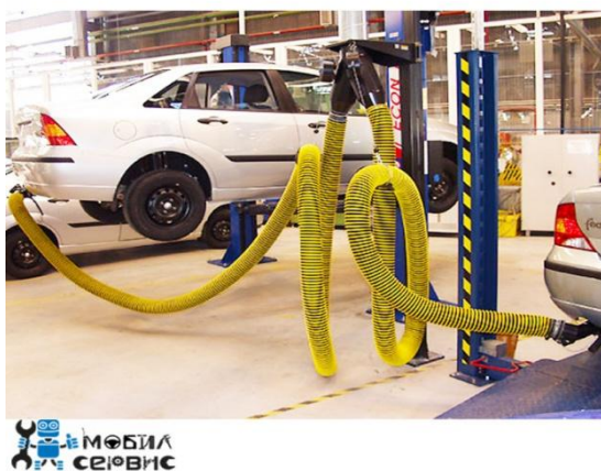
Рисунок 1.2 – устройство ДРОППЕР с вентилятором для удаления выхлопных газов DPF-100-6.
