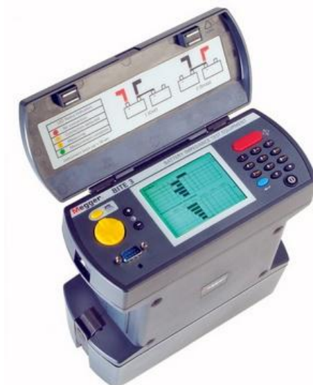
Рисунок 3.1 Прибор ВІТЕ 3 для тестирования аккумуляторных батарей
