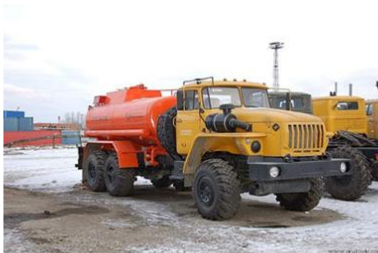
Рисунок 1.2 – Топливный заправщик АТЗ-10 на шасси автомобиля Урал-4320-1912-40
