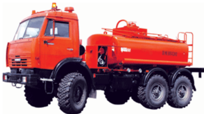
Рисунок 1.1 - Топливный заправщик АТЗ-56152-010-30 на шасси автомобиля Камаз 43114 -1912
