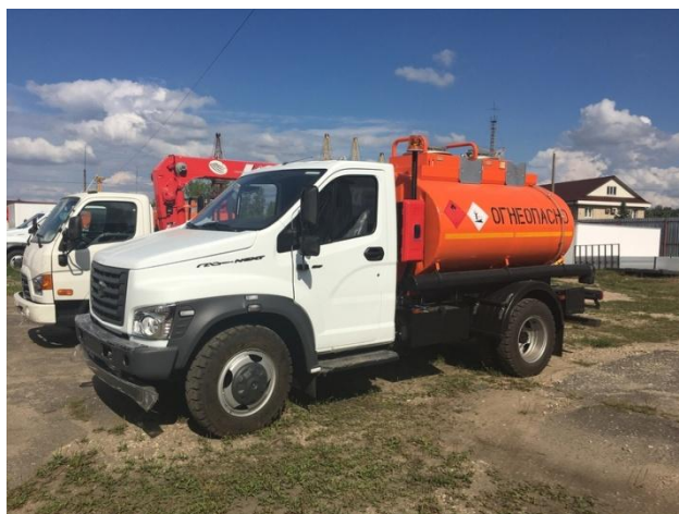
Рисунок 1.4 – Топливный заправщик ГАЗ-С41R13-10 на базе "ГАЗон NEXT"
