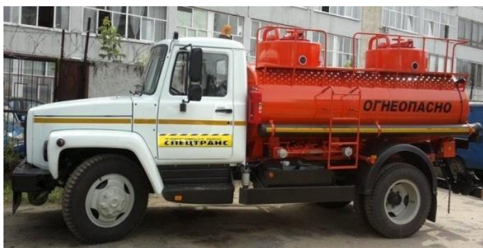
Рисунок 1.3 – Топливный заправщик АТЗ 36135-011 на шасси ГАЗ 3309
