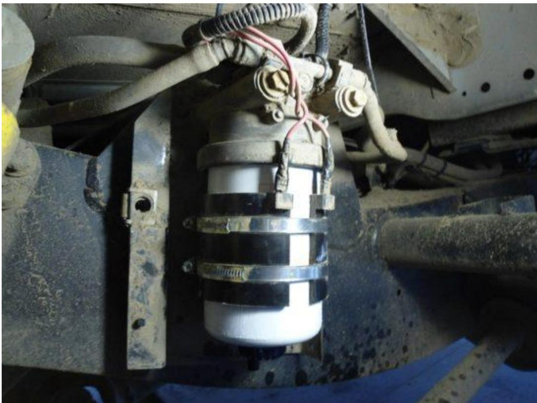
Обогреватель бандажного типа на топливном фильтре
