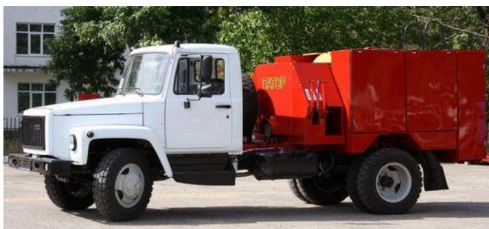
Рисунок 2 – Передвижной агрегат технического обслуживания на базе ГАЗ 3307
