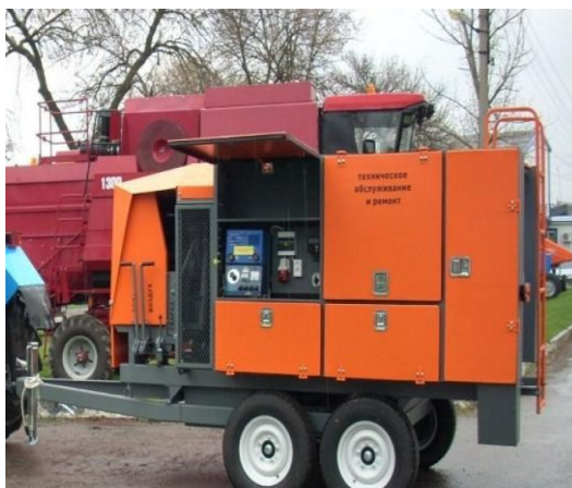
Рисунок 1.1 – Прицепной агрегат технического обслуживания и ремонта с энергоустановкой ПАТОР
