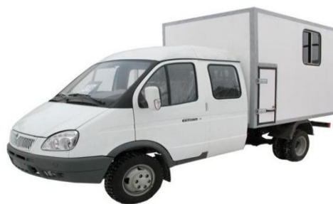
Рисунок 1.3 - Передвижная мастерская на базе автомобиля ГАЗ-3302
