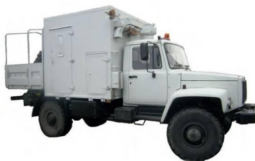
Рисунок 1.5 – Машина технической помощи МТП-1 на шасси ГАЗ-3308
