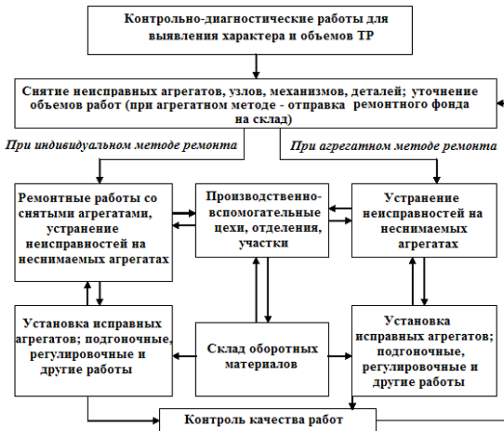
Рисунок 1.1 – Схема процесса текущего ремонта автомобилей
