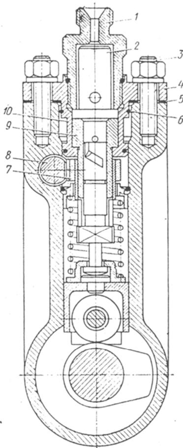
Рисунок 1.3 – Топливный насос высокого давления марки Friedmann – Maier
