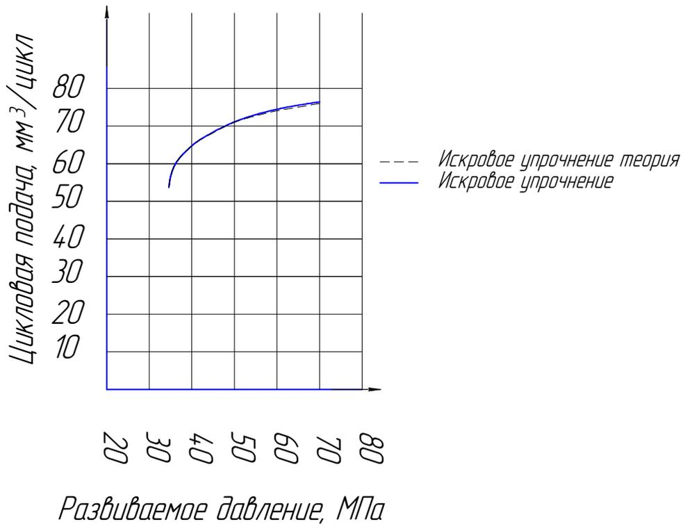
Рисунок 4.12 – График схождения теоретической и экспериментальной кривых при исследовании плунжера, упрочненного по комплексной технологии искрового легирования по параметрам, цикловая подача, развиваемое давление.
