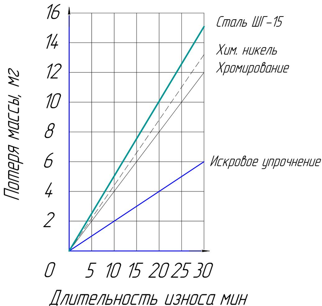
Рисунок 3.6 – Графики зависимостей потери массы натуральных образцов с покрытиями и без покрытия от длительности износа
