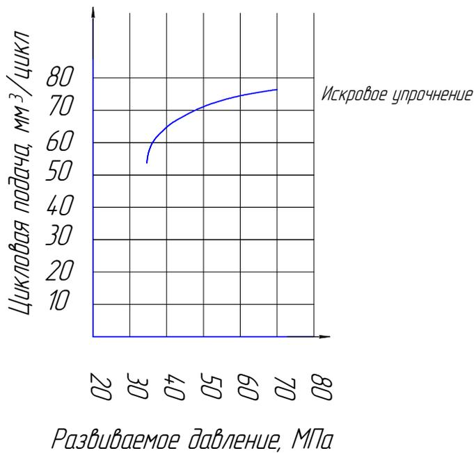
Рисунок 4.8 – Теоретические зависимости цикловой подачи топлива ТНВД модели 33-02 двигателя автомобиля КамАЗ 5320 с плунжерной парой после обработки искровым упрочнением от развиваемого давления
