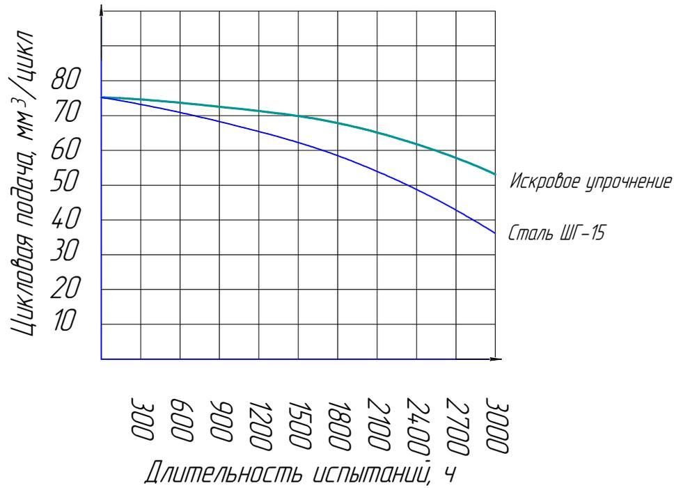
Рисунок 4.5 – Теоретические зависимости цикловой подачи заводского плунжера плунжерной пары и парой с искровым упрочнением от наработки
