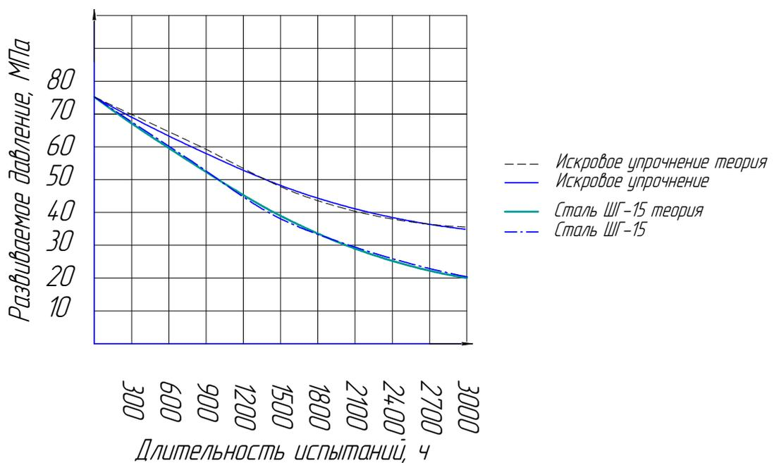
Рисунок 4.10 – График сходимости теоретических и экспериментальных кривых при исследовании серийного плунжера материал ШХ-15 и плунжера, упрочненного по комплексной технологии искрового легирования по параметрам развиваемое давление, длительность испытания.
