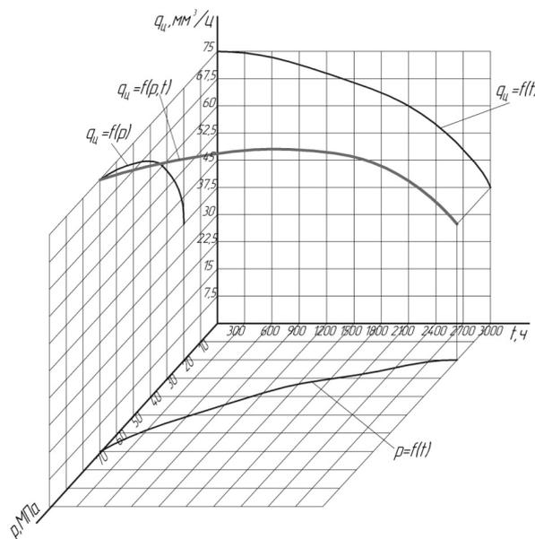
Рисунок 4.4 – Ортогональные проекции цикловой подачи топлива плунжерной пары от его наработки и развиваемого плунжерной парой давления
