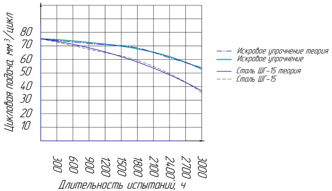
Рисунок 4.9 – График сходимости теоретических и экспериментальных кривых при исследовании серийного плунжера материал ШХ-15 и плунжера, упрочненного по комплексной технологии искрового легирования по параметрам цикловая подача, длительность испытания.
