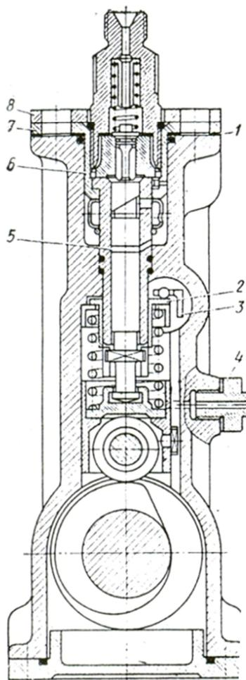
Рисунок 1.2 – Топливный насос высокого давления марки Bosch
