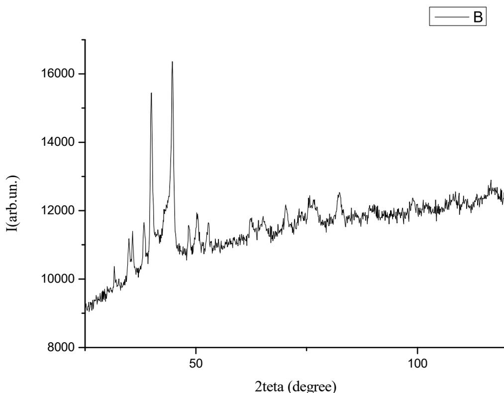
Рисунок 3.11- Рентгенограмма образца стали после обработки
