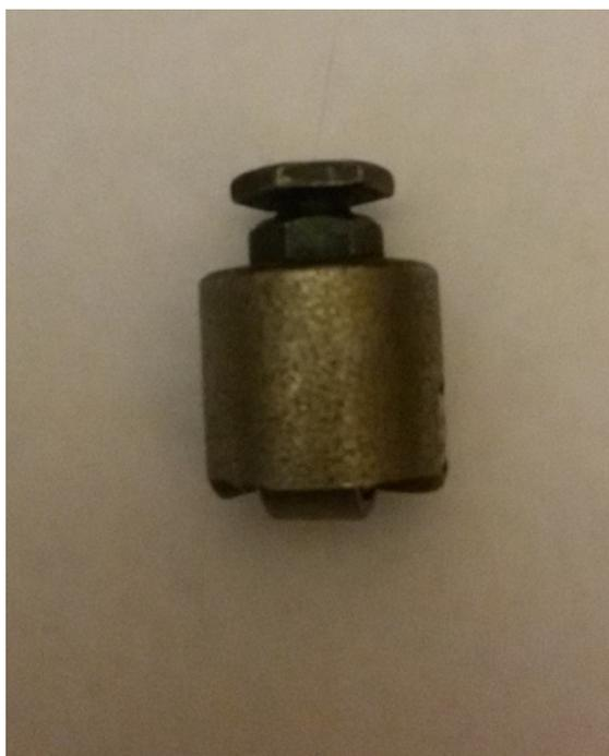
Рисунок 4.1 – Толкатель ТНВД модели 33-02, упрочненный по комплексной электроискровой технологии
