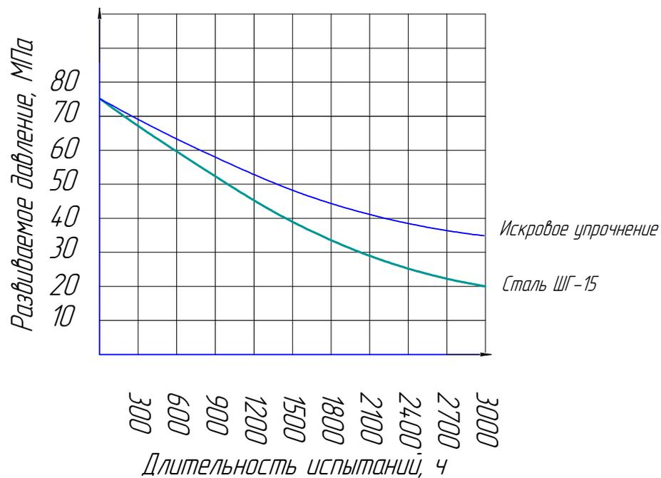
Рисунок 4.6 – Теоретические взаимосвязи развиваемого давления заводского плунжера плунжерной пары с парой с искровым упрочнением от наработки
