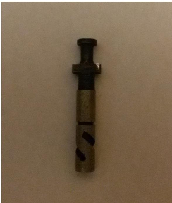
Рисунок 4.2 – Плунжер ТНВД модели 33-02 упрочненный по комплексной электроискровой технологии
