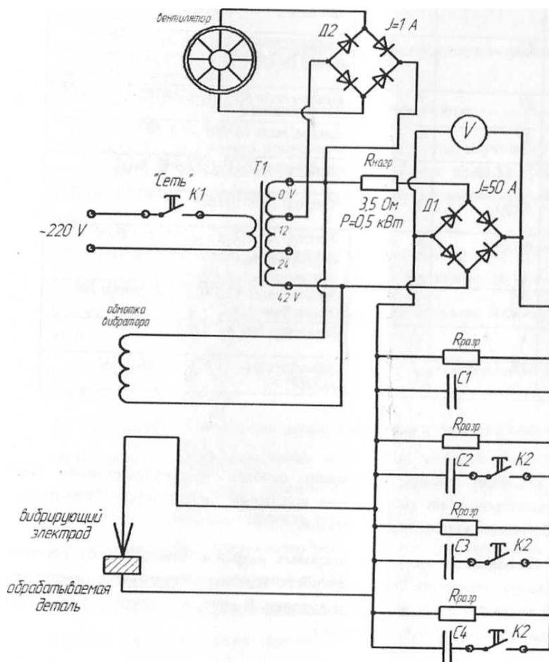
Рисунок 2.2. Электрическая схема электроискровой установки.
