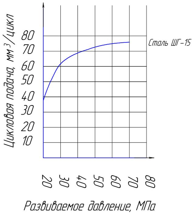
Рисунок 4.7 – Теоретические зависимости цикловой подачи с заводской плунжерной парой от развиваемого давления
