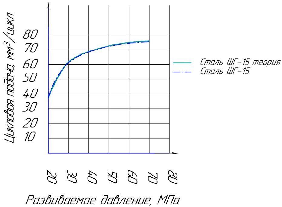
Рисунок 4.11 – График схождения теоретической и экспериментальной кривых при исследовании серийного плунжера материал ШХ-15 по параметрам, цикловая подача, развиваемое давление.
