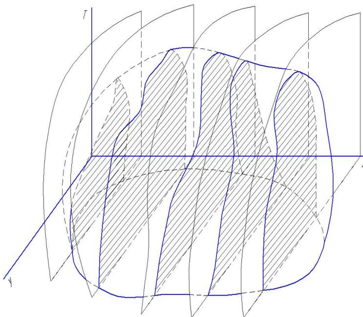
Рисунок 4.3 – Область нахождения цикловой подачи топлива ТНВД модели 33-02 двигателя автомобиля КамАЗ 5320 с заводской плунжерной парой в зависимости от развиваемого плунжерной парой давления и наработки
