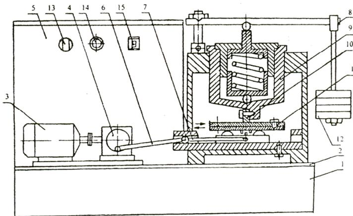
Рисунок 3.2 – Схема машины трения 77MT-1
