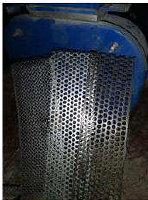
Рисунок 4.2 –Сменные решета с диаметром отверстий 2,4 и 6 мм.
