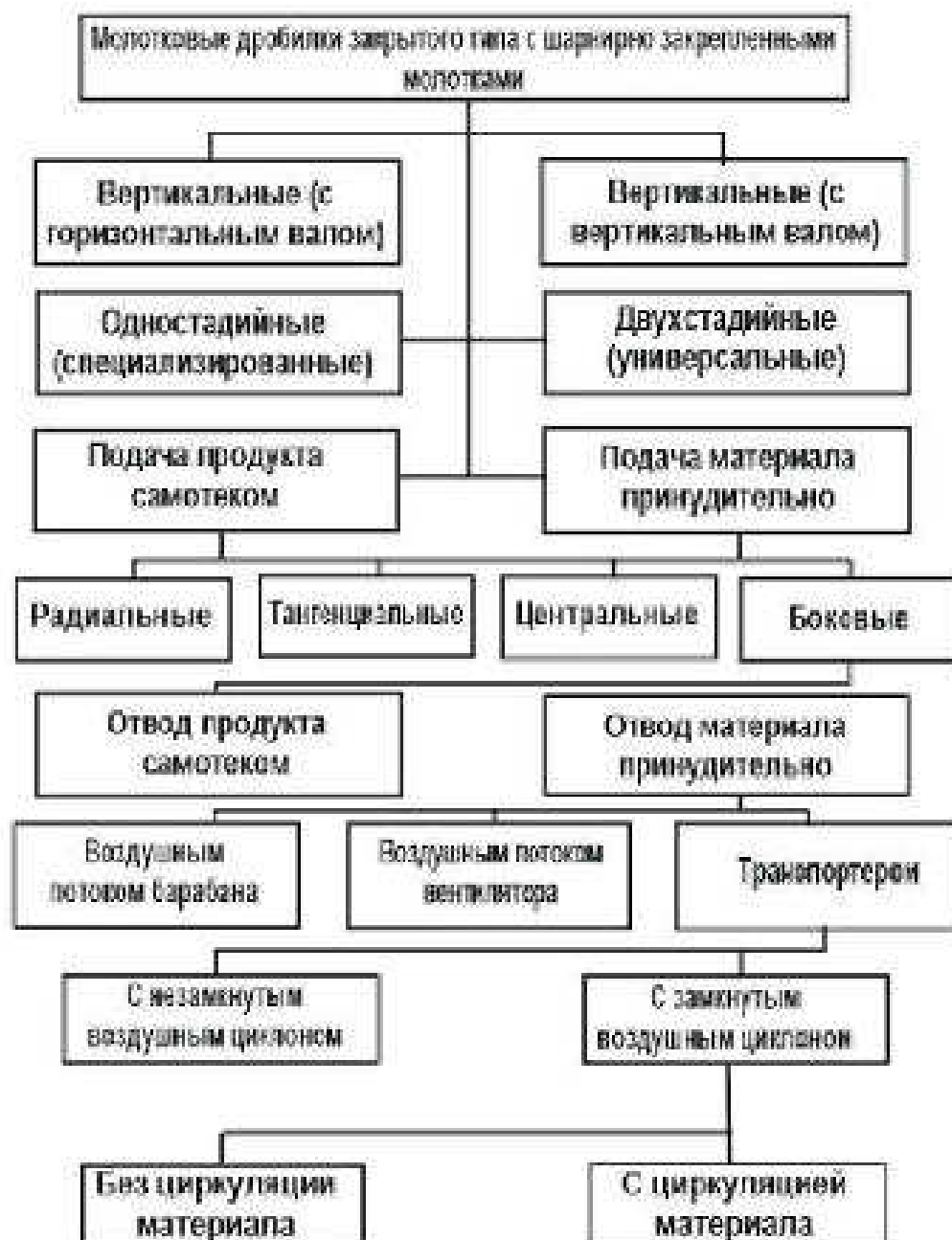
Рисунок 1.3 - Классификация молотковых кормодробилок по способу организации рабочего процесса
