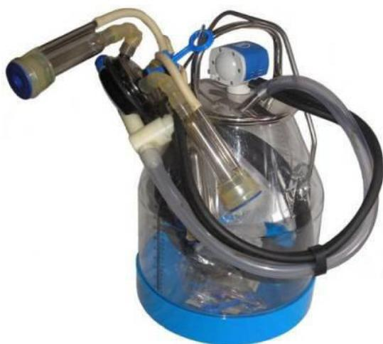
**Рисунок 1.3 – Доильный аппарат «Хозяин» в комплекте с ведром из пластика (Италия)**
