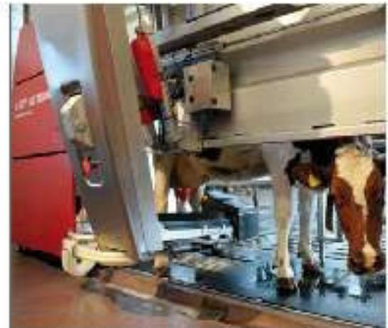
**Рисунок 1.12 – Процесс работы доильного робота**
