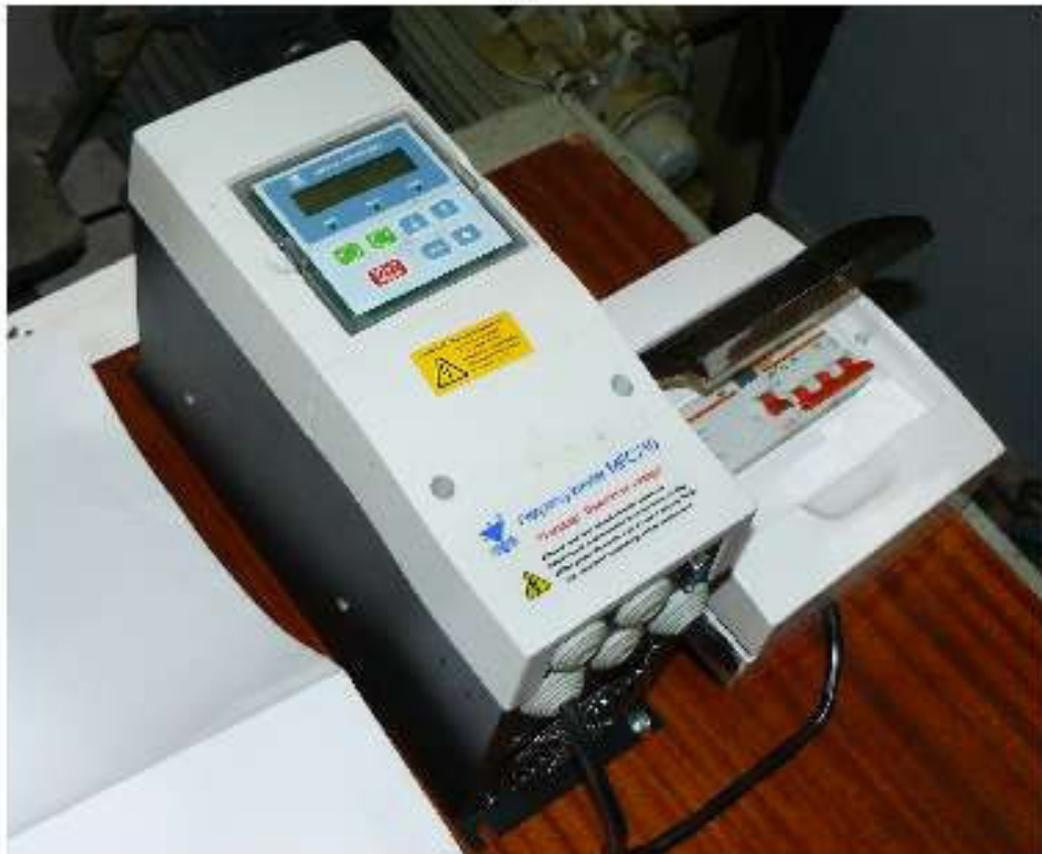
**Рисунок 3.8 – Преобразователь частоты MFC 710**
