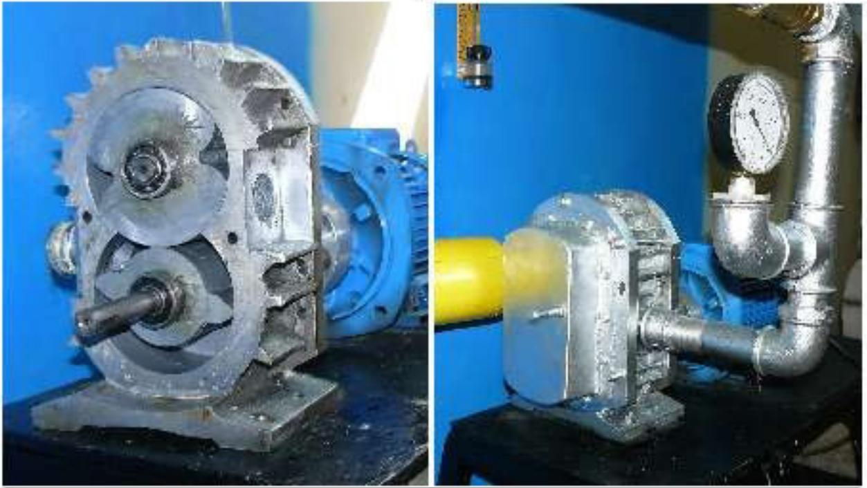
**Рисунок 3.1 – Экспериментальный двухступенчатый вакуумный насос**
