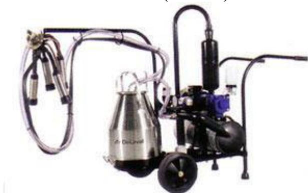
**Рисунок 1.5 – Доильная установка ММУ с одним ведром**
