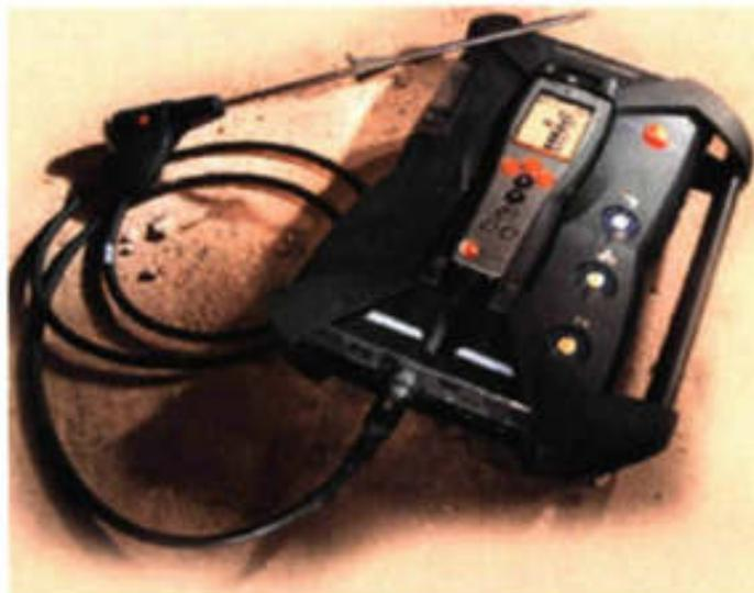
Рисунок 3.7 – Общий вид газоанализатора TESTO-350
