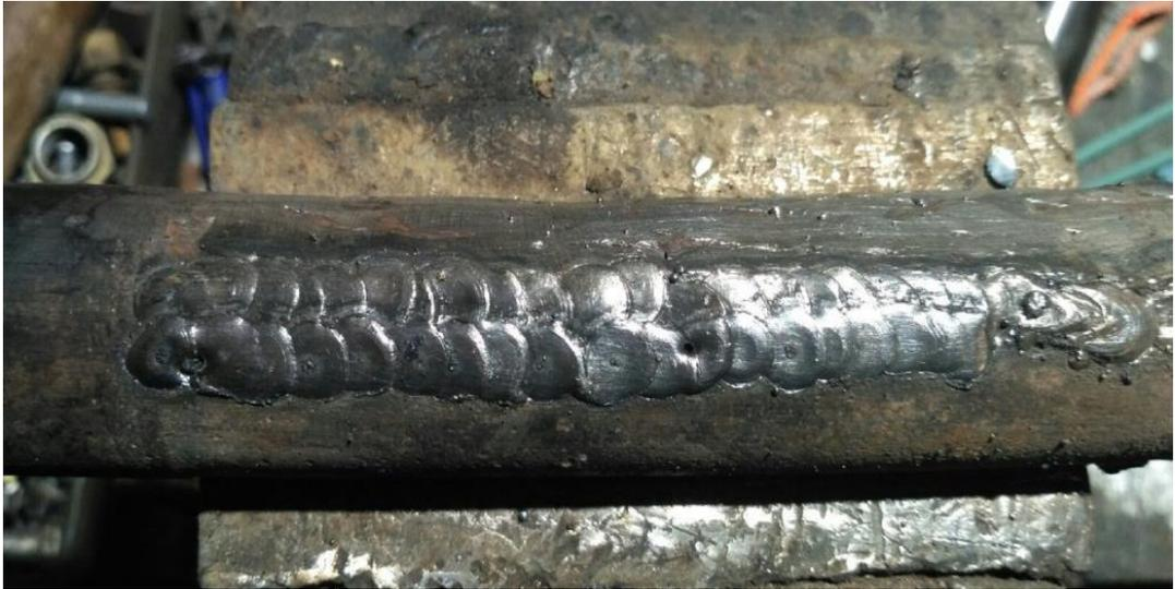
Рисунок 4.2 – Наплавленный слой металла на поверхность гусеничного пальца
