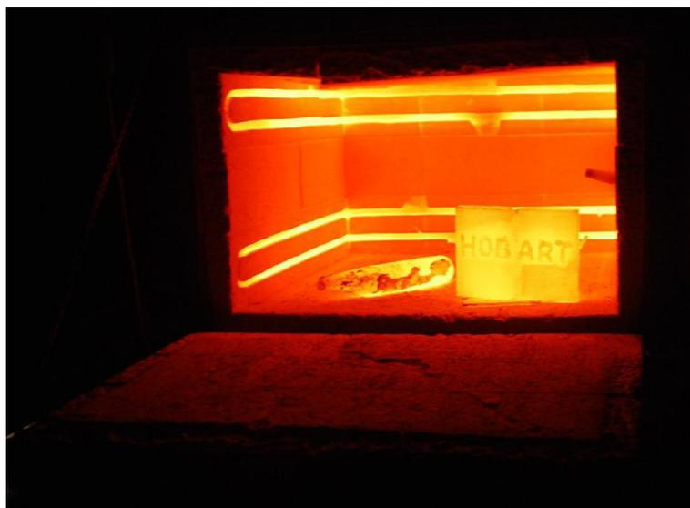
Рисунок 3.10 – Цементация в печи
