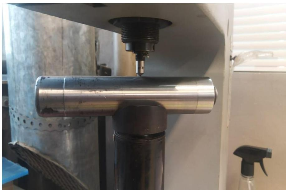
Рисунок 4.5 – Замер твердости восстановленных пальцев
