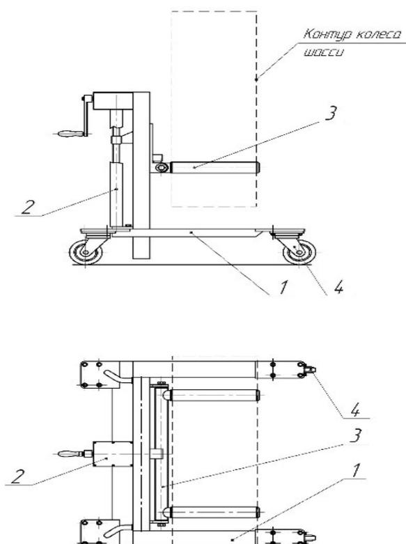
Рисунок 3.1 – Приспособление для снятия-установки и транспортировки колеса автомобиля КАМАЗ
