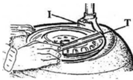
Рисунок 1.2 - Снятие покрышки с обода (разбортовка)
