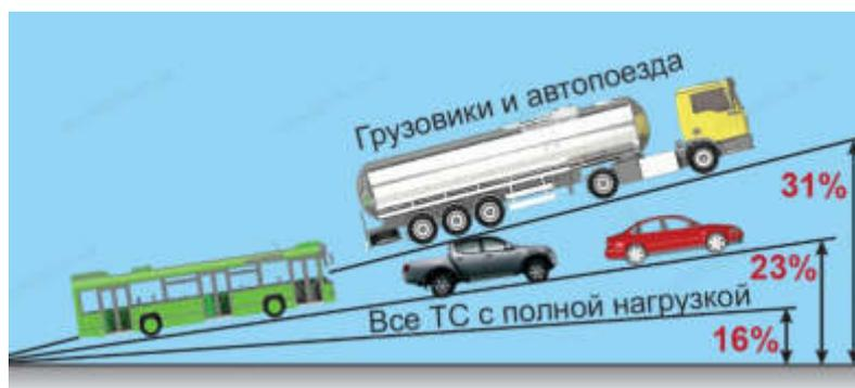
Рисунок 1.1 – Проверка стояночной тормозной системы
