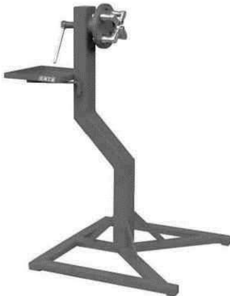
Рисунок 1 – Стенд для разбора коробок передач, одностоечный, г/п 150 кг.
