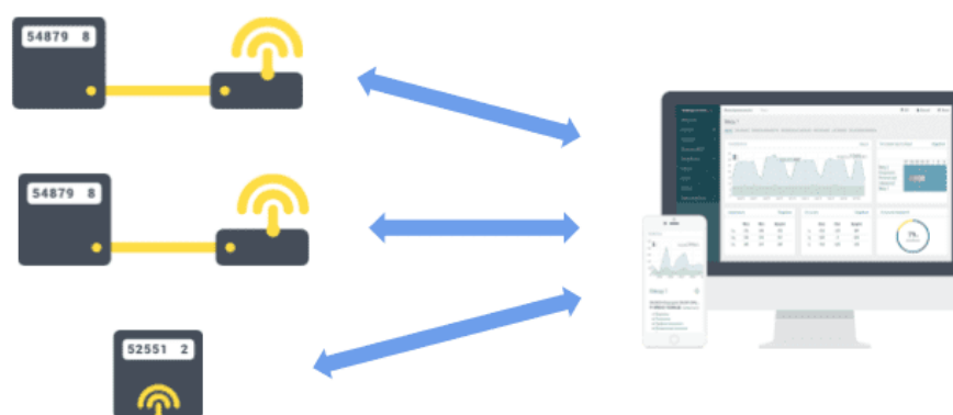
Рис.3.1. Обмен данными электросчетчика с сервером интеллектуальной системы учета
