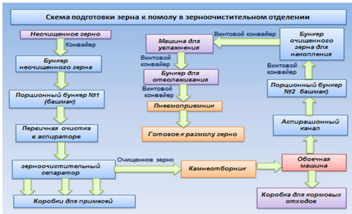
Рисунок 3.1. - Схема подготовки зерна к размолу в зерноочистительном агрегате
