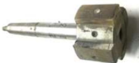
Рисунок 4.2 Образец, подготовленный для испытаний с высверленными лунками.
