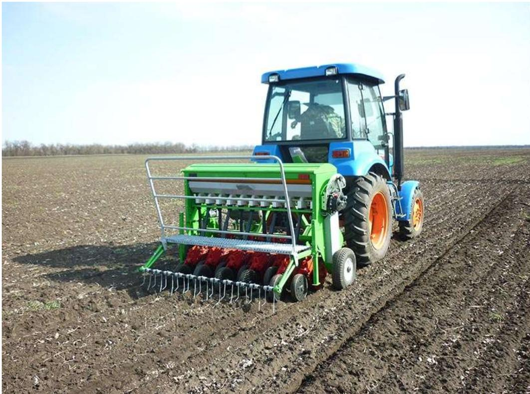
Рисунок 1.2 – Сеялка селекционная навесная СС-11.
