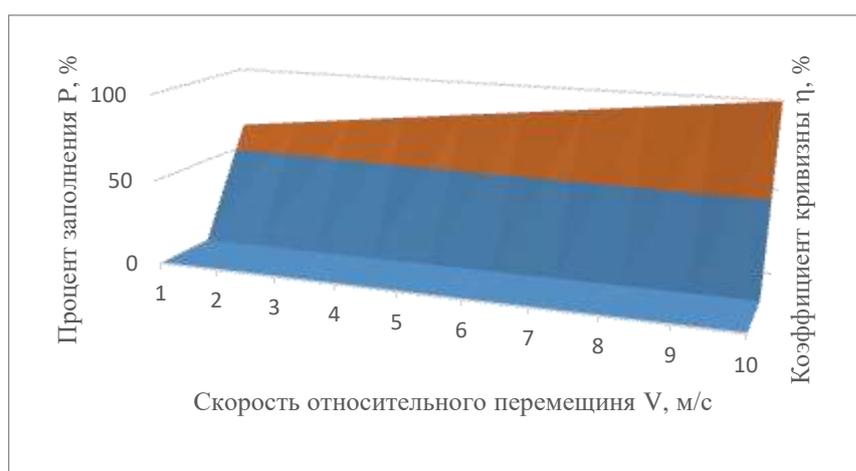
Рисунок 4.1 - Изменение процента заполнения (P) ячеек семенами в зависимости от коэффициента кривизны (η) ячеистой поверхности и скорости её относительного перемещения (V)
