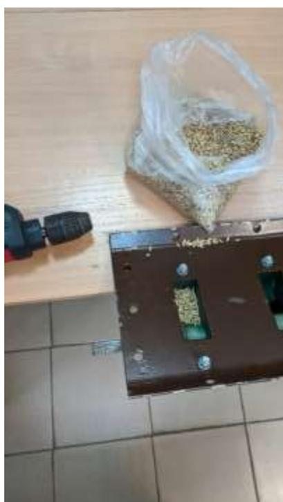
Рисунок 4.9 – Проведение лабораторных испытаний на травмируемость семян с катушечным высевающим аппаратом.
