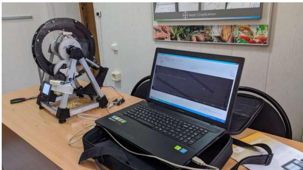
Рисунок 4.10 – Проведение экспериментов на лабораторной установке с барабанным высевочным аппаратом.
