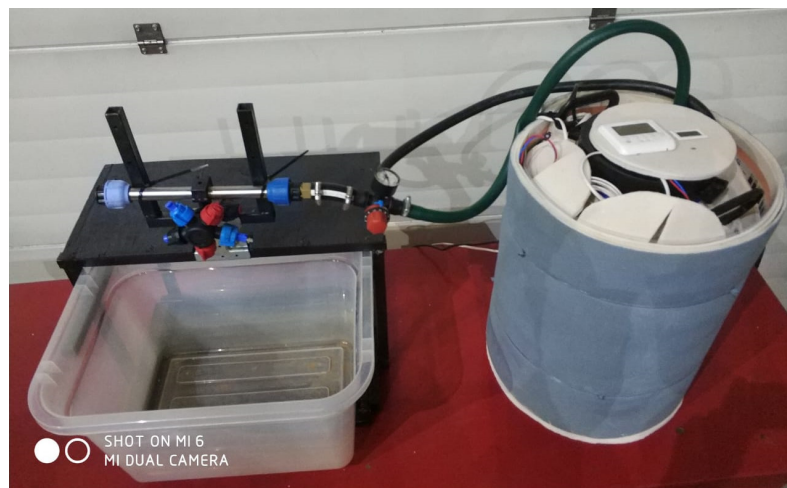
Рисунок 3.2 – Общий вид установки для испытания распылителей
