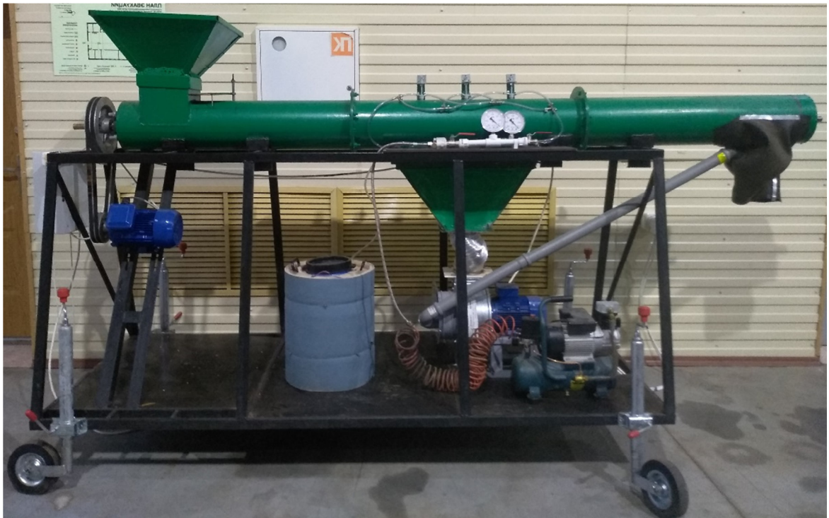
Рисунок 3.4 – Экспериментальный образец пневмомеханического протравливателя
