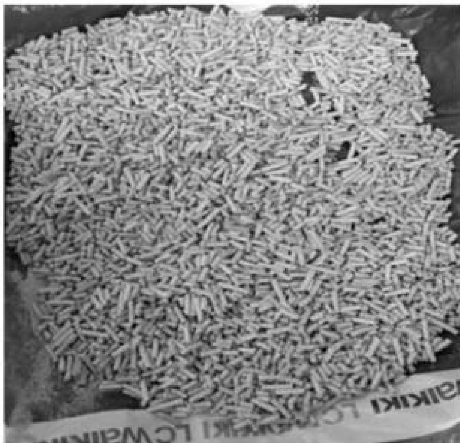
Рисуно к 4.5 – Резултат по сле измелъчения и гранулирования про дукта
