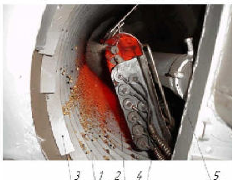
1 – направляющие рейки; 2 – ИК-излучатель; 3 – барабан; 4 – камера ИК-излучения; 5 – привод
