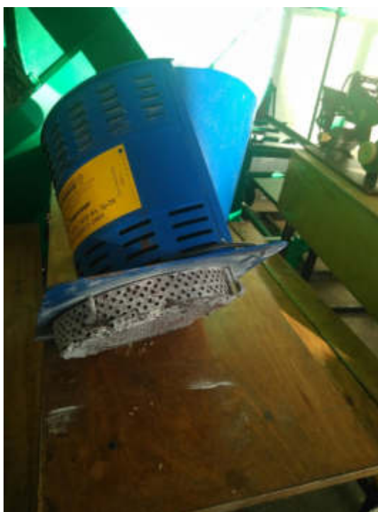
Рисунок 4.2 Существующий измельчитель со стандартной обечайкой
