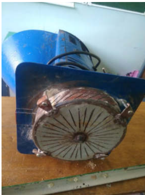
Рисунок 2.3 – Расположение надрезов на предлагаемом устройстве для измельчения зерна
