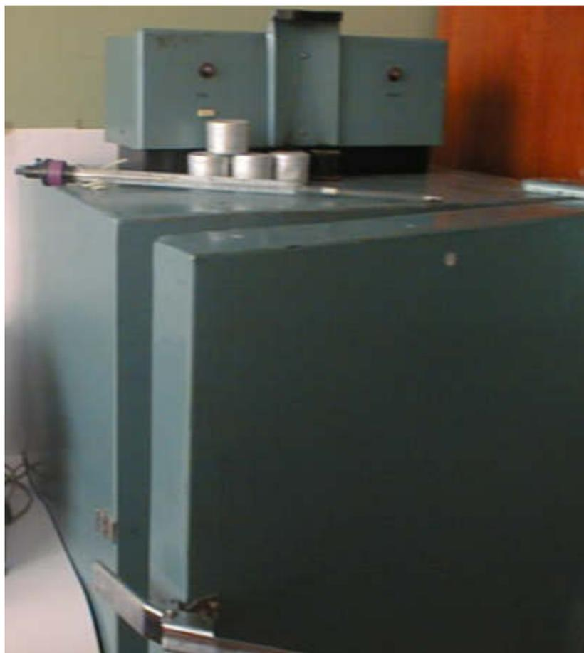
Рисунок 3.1 - Шкаф сушильный стерилизационный ШСС – 80п, термометр
