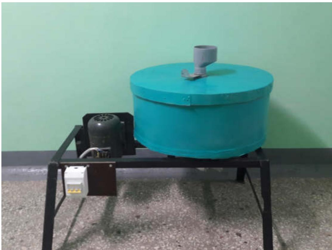
Рисунок 3.4 – Общий вид устройства для шелушения зерна гречихи с вариативной декой
