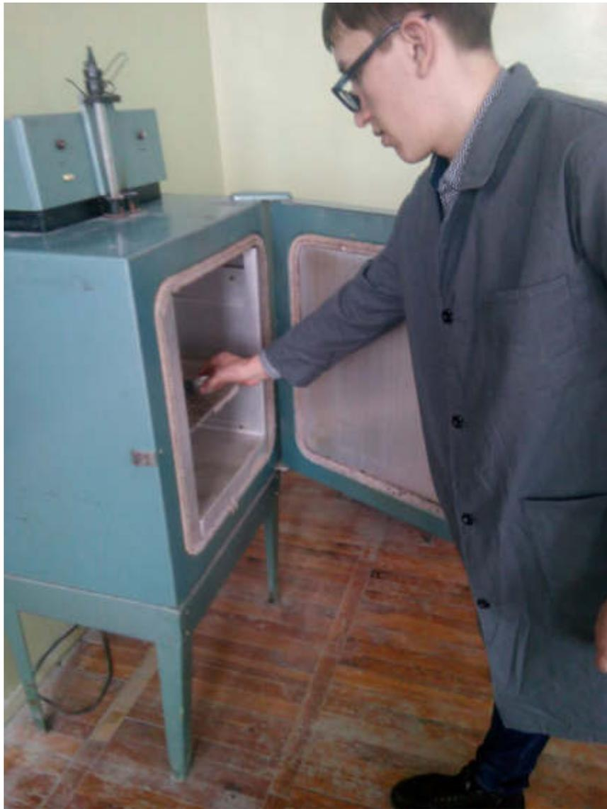
Рисунок 3.3 - Процесс помещения бюксов в шкаф
