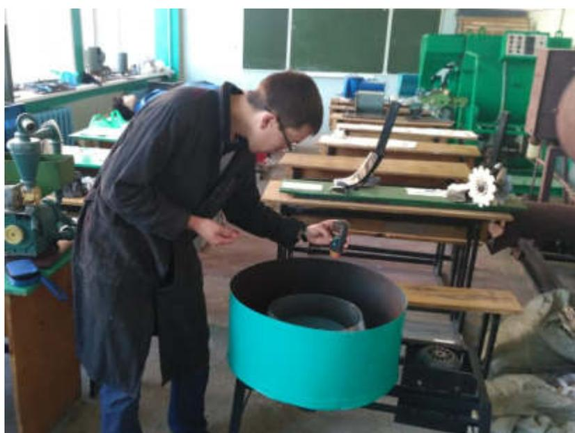
Рисунок 4.5 – Измерение частоты вращения лопастного ротора и деки.
