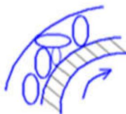
Рисунок 1.4 - Шелушение трением об абразивную поверхность
