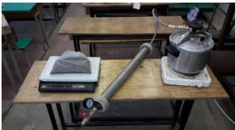
Рисунок 4.3 – Лабораторная установка для пропаривания зерна
