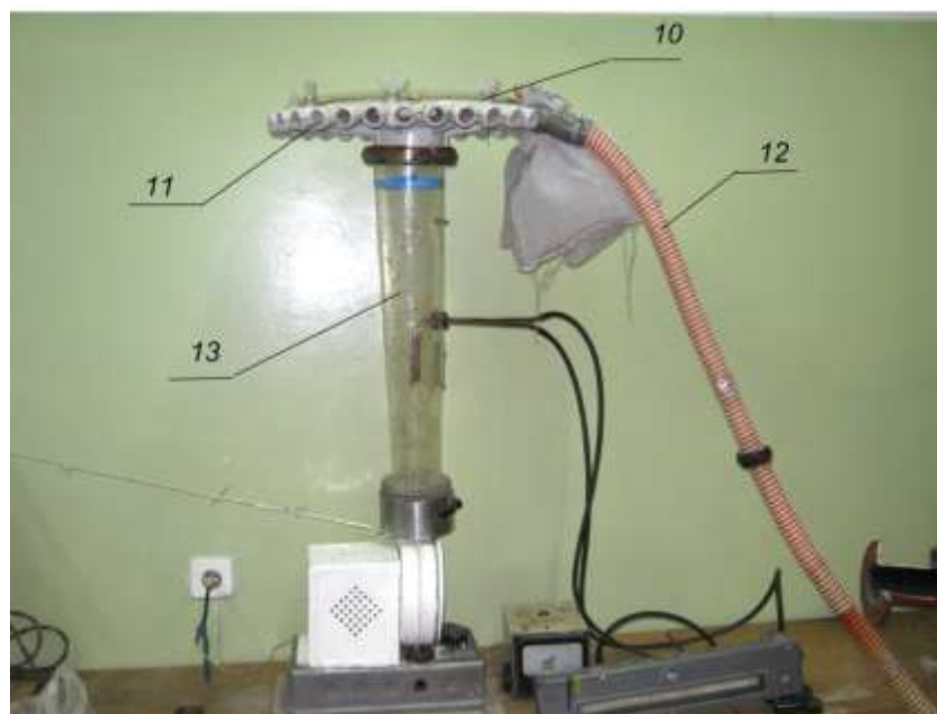
10 – распределитель семян; 11 – отводящие патрубки; 12 – семяпровод; 13 – семявоздушная смесь.
