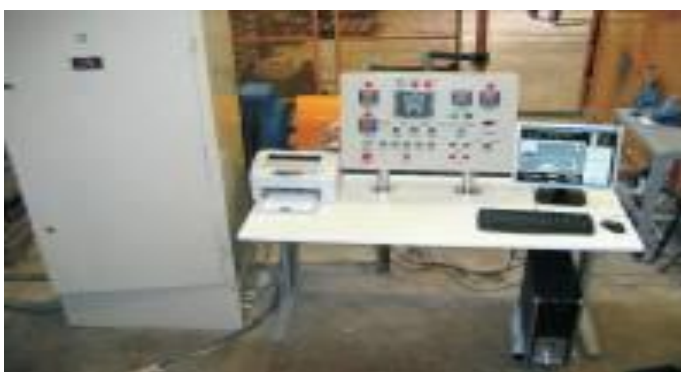
Рисунок 1.3 - Автоматизированный комплекс испытания компрессора
