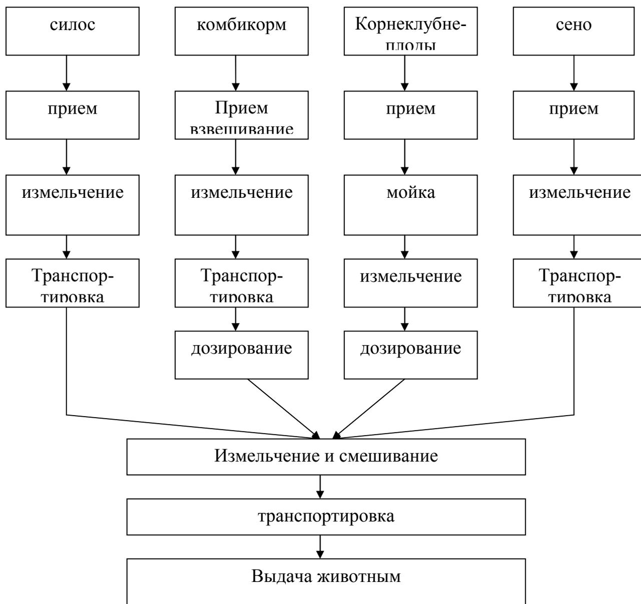
Рисунок 2.1 - Технологическая схема кормоцеха.
