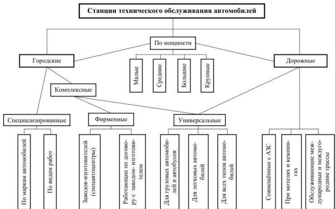
Рис. 1.1 Классификация станций технического обслуживания автомобилей
