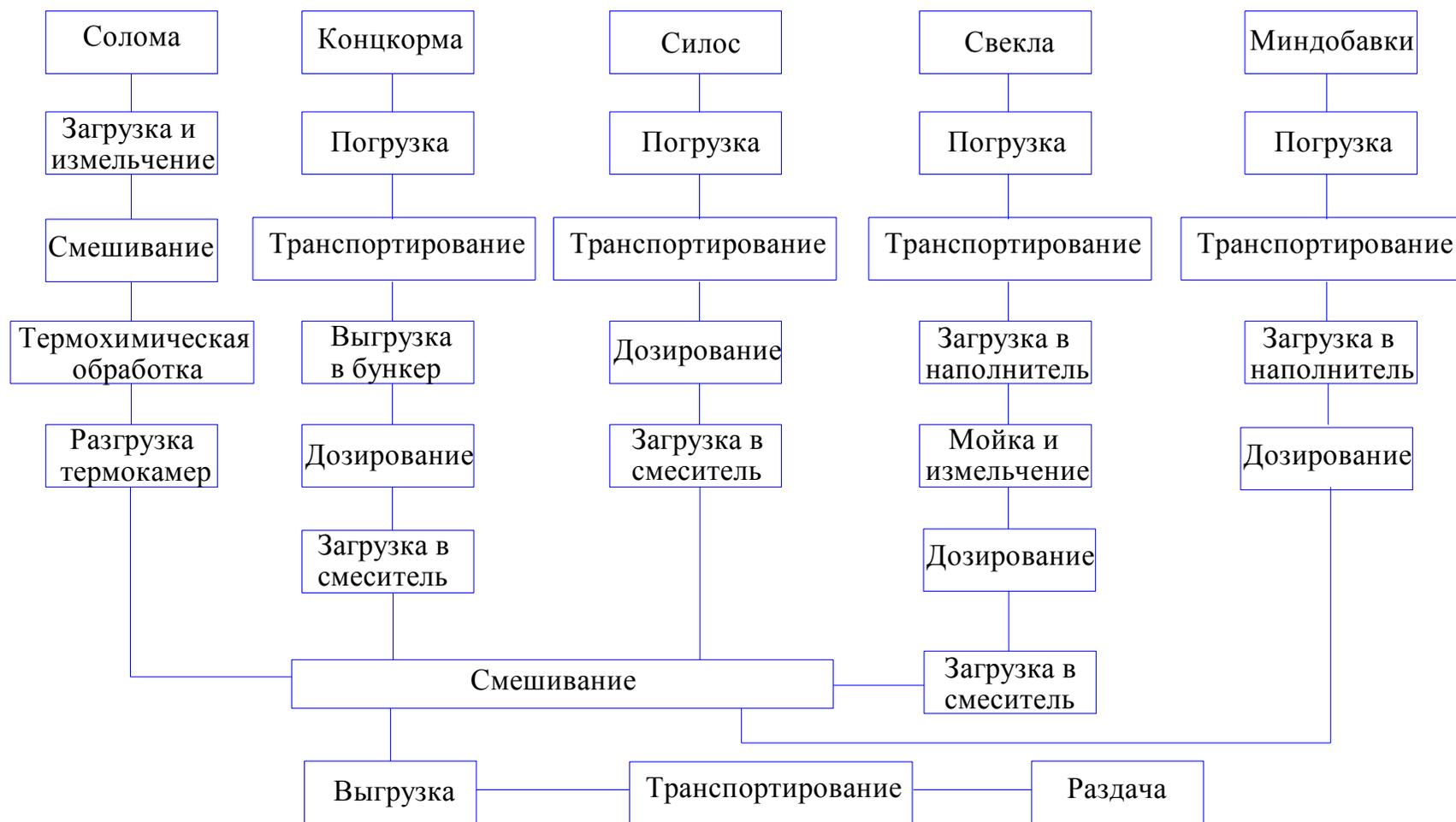
Рисунок 2.1 – Схема предлагаемого технологического процесса приготовления кормов.
