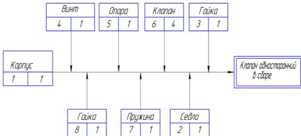
Рисунок 5.1 – Схема сборки одностороннего клапана
