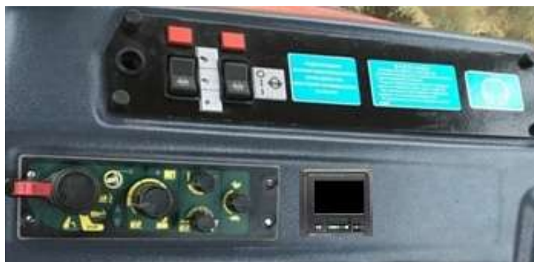
Рисунок 4.18 – Место установки бортового компьютера.
