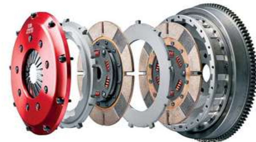
Рисунок 3.4 – Двухдисковая сухая фрикционная муфта сцепления
