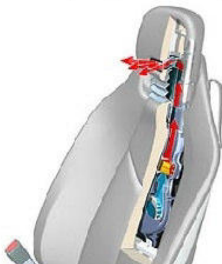
Рисунок 3.6 – Схема и принцип работы активного подголовника
