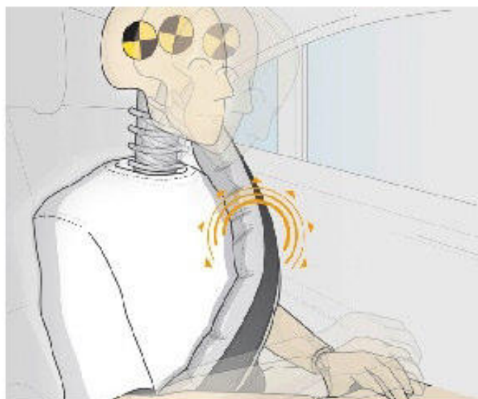
Рисунок 3.10 – Испытания надувных ремней на манекене
