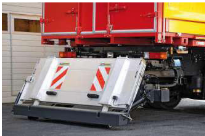
Рисунок 3.2 - Убирающийся под кузов складывающийся вдвое гидроборт MBV 1500 KUZF г/п 1500 кг.
