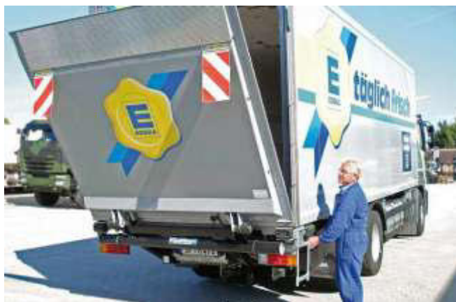
Рисунок 3.1 - Гидроборт консольного (рычажного) типа (мод. MBV 2000К г/п 2000 кг).
