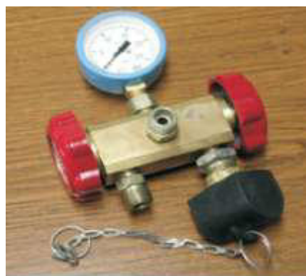
Рисунок 3.6 – Блок расходно-запорных вентилей с датчиком давления в баллонах.
