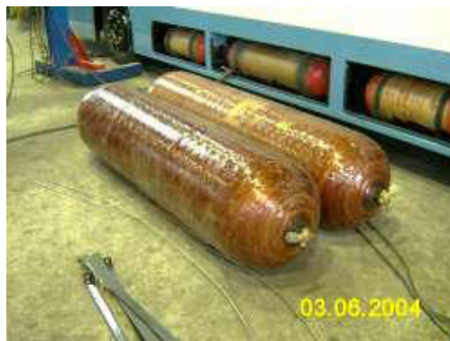
Рисунок 3.5 – Внешний вид облегченных балонов из легированной стали
