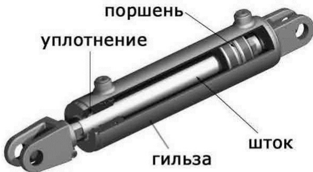
Рисунок 1.1 - Устройство гидроцилиндра.
