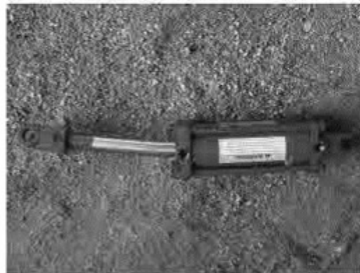
Рисунок 1.2 - Повреждения штока гидроцилиндра
