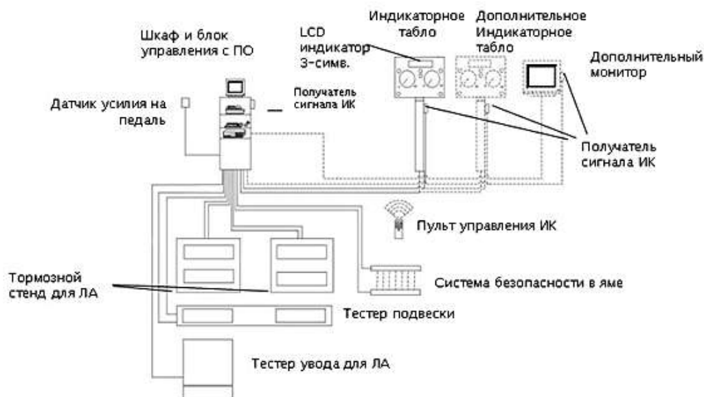
Рисунок 1.4 – Устройство и технологическая схема диагностической линии NTS 500.
