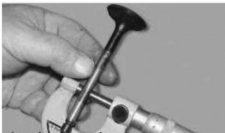
Рисунок 2.2 - Измерение диаметра стержней клапанов двигателя Д - 240.
