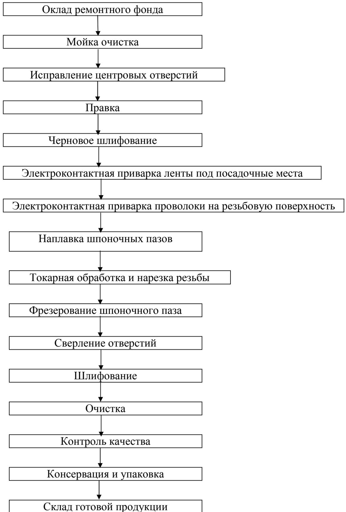
Рисунок 2.2 Схема технологического процесса восстановления гладких валов
