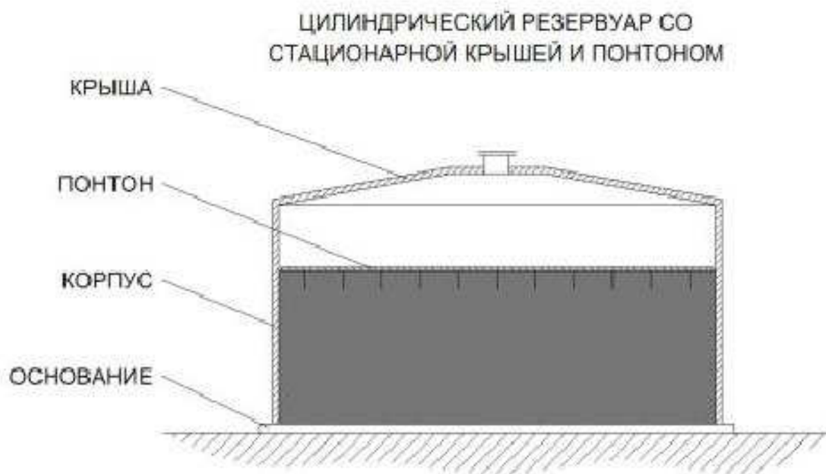
Рисунок 1.3 – Резервуар для хранения нефтепродуктов
