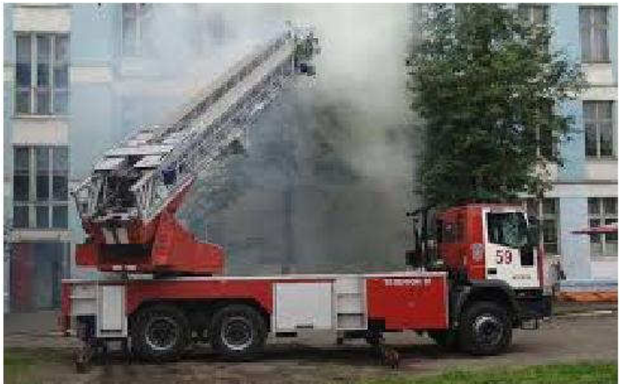
Рисунок 3.4 – Тушение пожара на высоте с использованием пожарной автолестницы
