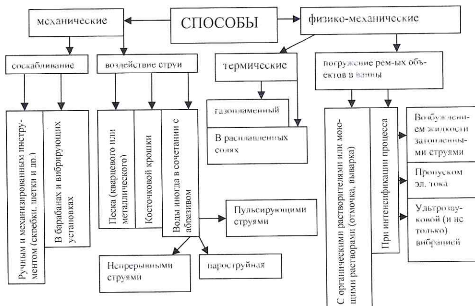
Рисунок 1.2 - Классификация способов очистки деталей машин
