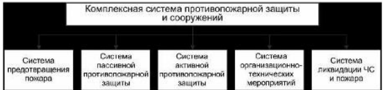
Рисунок 3.1 – Комплексная система противопожарной защиты зданий
