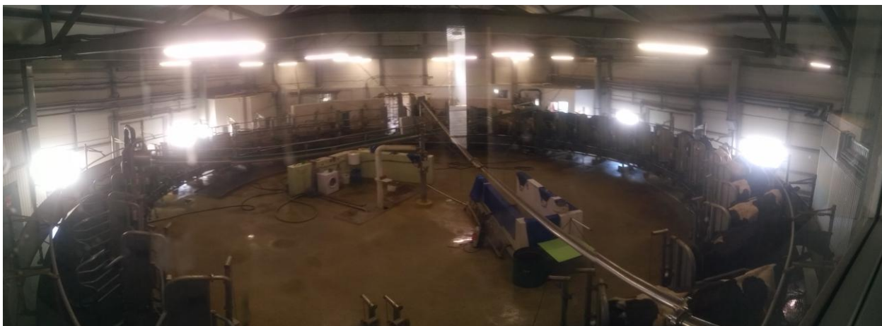
Фото 1.1 – Процесс доения коров; вращающаяся платформа установки «Карусель»
