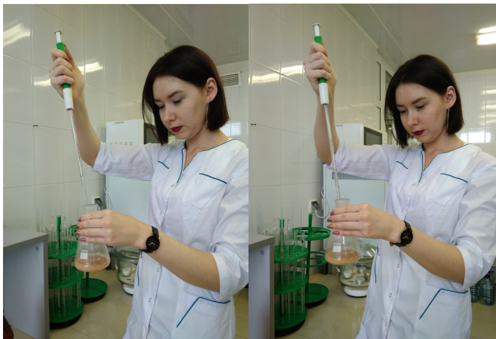
Рис.10 Добавление фенолфталеинаРис.11 Процесс титрования
