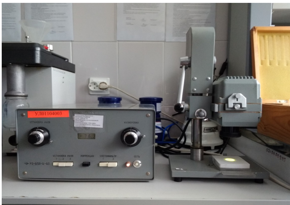
Рис.8 Прибор для определения белизны муки РЗ-БПЛ-Ц
