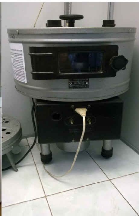
Рис.14 Определение влажности мякиша Рис.15 Шкаф сушильный СЭШ-3М
