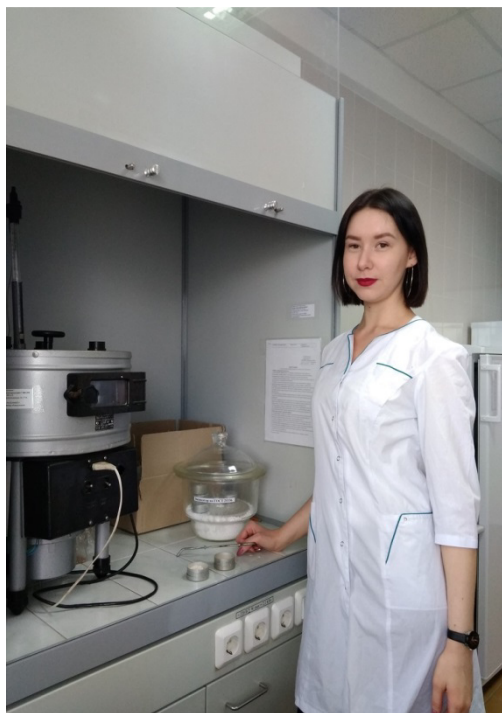
Рис.14 Определение влажности мякиша Рис.15 Шкаф сушильный СЭШ-3М
