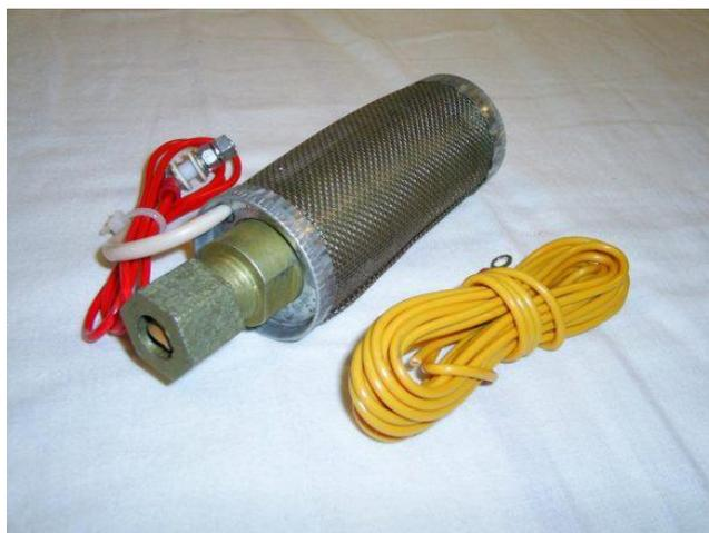
Топливозаборник прогревается через специальную насадку, которая не даёт топливу замерзнуть
