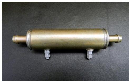
Постоянный подогрев дизтоплива реализуют как при помощи электрического нагревательного элемента, так и путем установки жидкостных теплообменников. Указанный теплообменник представляет собой решение, позволяющее нагретой в [системе охлаждения](#) жидкости циркулировать в том месте, где необходим постоянный подогрев топлива.
