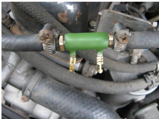
Проточный подогрев позволяет топливу постоянно находиться в нужном диапазоне температур
