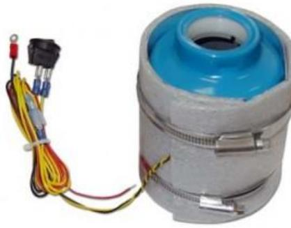
Ленточный тип подогревателей может быть установлен на разных участках топливной системы дизельного двигателя. Особенно это актуально при необходимости реализации обогрева топливопроводов на отрезках от топливного бака до фильтра сепаратора, а также после сепаратора до фильтра тонкой очистки. Такие подогреватели осуществляют нагрев магистрали перед пуском двигателя и поддерживают температуру в процессе езды на автомобиле.
