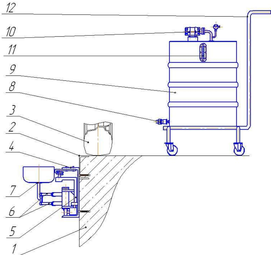
Рисунок 3.1 – Устройство установки слива масла.
