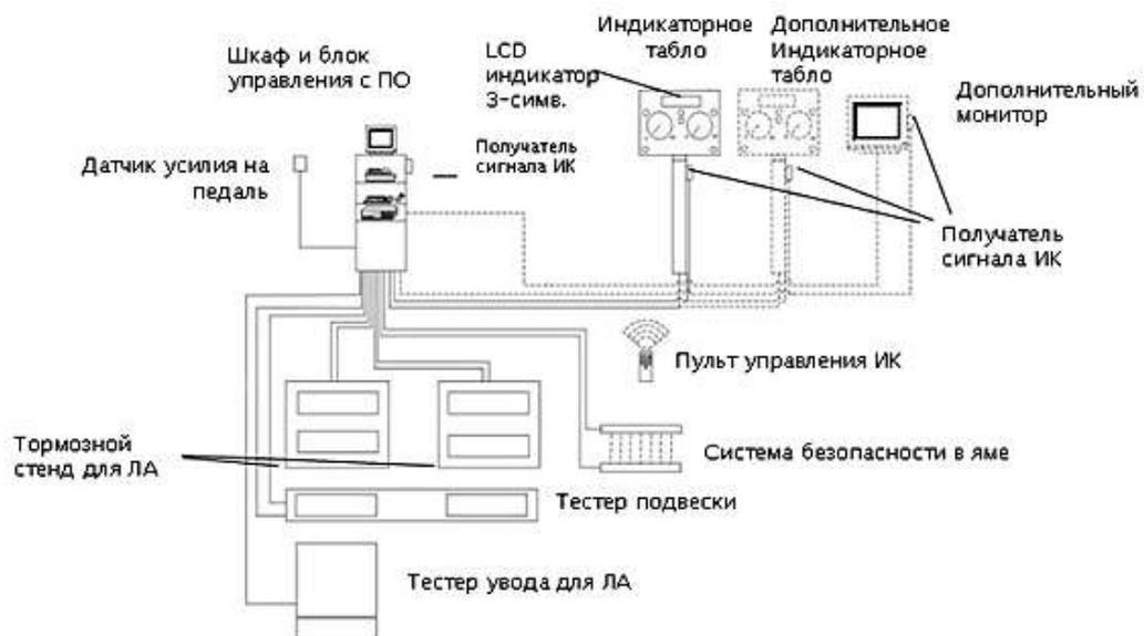
Рисунок 1.4 – Устройство и технологическая схема диагностической линии NTS 500.
