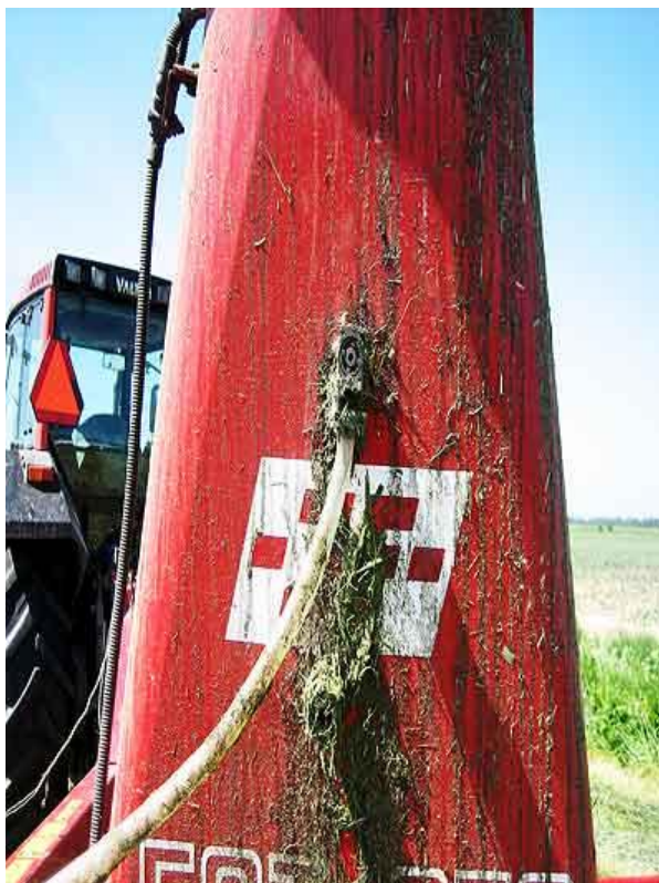
Рисунок 1.3 Место расположения форсунки на силосопроводе
