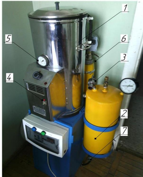
1 – реактор; 2 – газгольдер; 3 – горелка; 4 – включатель; 5 - термометр;
