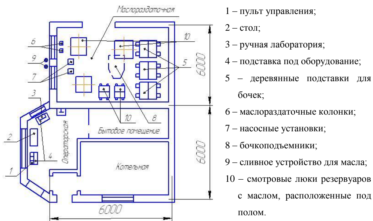
Рисунок 1.2 – План операторской с маслоскладом и маслораздаточной (нефтесклада емкостью 40, 80 и 150 \text{ м}^3 )
