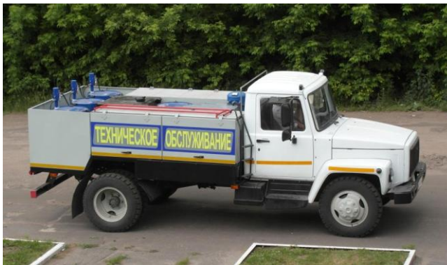
Рисунок 1.1 – Агрегат технического обслуживания АТО-9994
