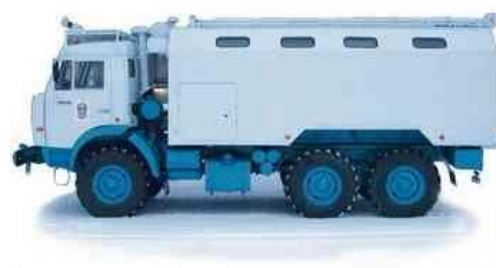
Рисунок 1.5 – МРЭ-АМ2.2 – в кузове-фургоне К-5350 установленном на шасси КамАЗ-5350
