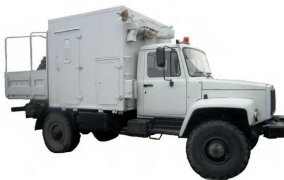
Рисунок 1.3 – Машина технической помощи МТП-1 на шасси ГАЗ-3308
