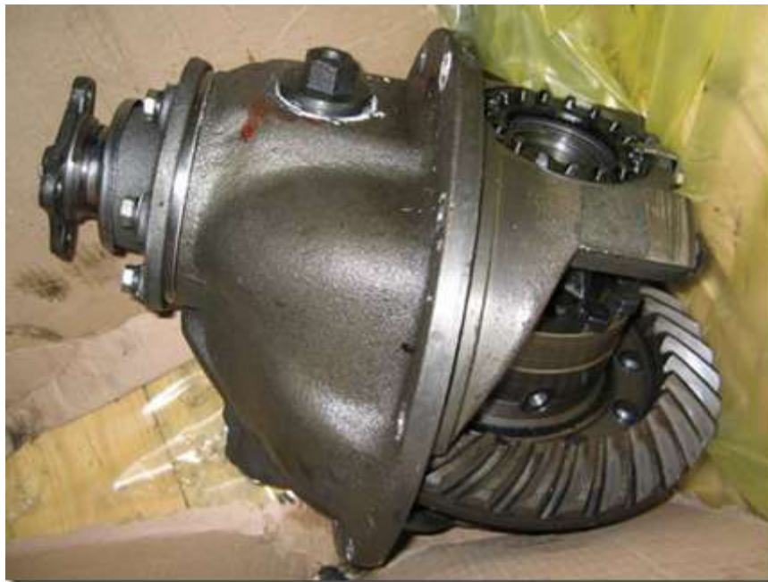
Рисунок 1.2 - Разобранный редуктор ГАЗ - 53
