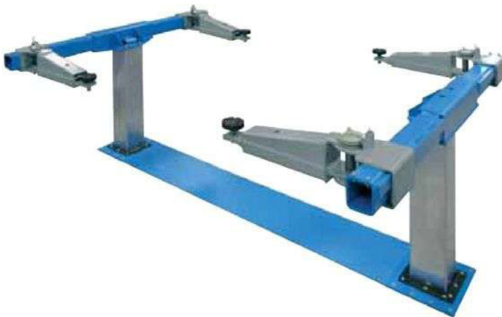
Рисунок 1.6 – Плунжерный электрогидравлический подъемник Ravaglioli
